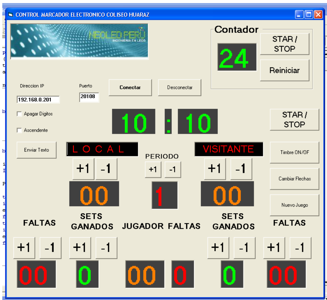
Figura 2. Control del marcador principal y segunderos.
